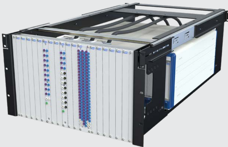
그림 12 - FIU 새시를 BoB에 플러그인 모듈을 통해 직접 연결함으로써 케이블링을 최소화하여 더 컴팩트하고 신뢰성 있는 설계가 가능해지며 신호 무결성이 향상.
