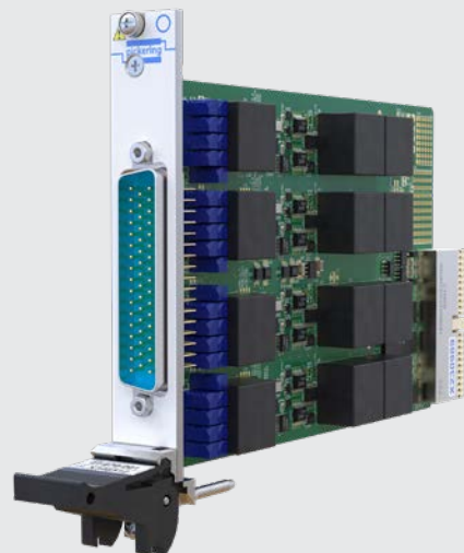
그림 8 - The LVDT, RVDT, 리졸버 모듈 (41/43-670)은 공통 여기 신호를 사용하여 최대 5-선 또는 6-선 VDT/리졸버 4개, 또는 4-선 LVDT/RVDT 8개를 시뮬레이션.
