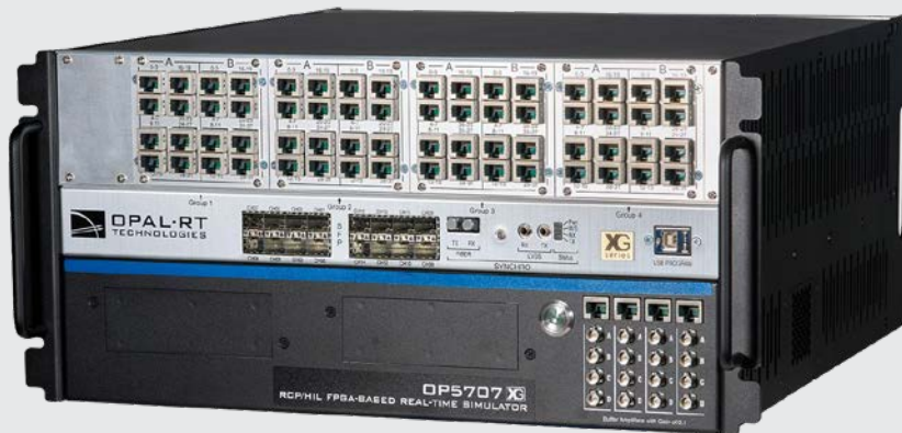
그림 5 - OPAL-RT OP5707XG는 Intel® Xeon® 프로세서, 최대 16 GB RAM, 250 GB SSD, 4개의 이더넷 포트(1 Gbps 2개, 10 Gbps 2개), USB 3.2 포트, HDMI 및 VGA 출력, 그리고 1 마이크로 초 미만의 실시간 시뮬레이션을 위한 Virtex®-7 FPGA를 탑재
