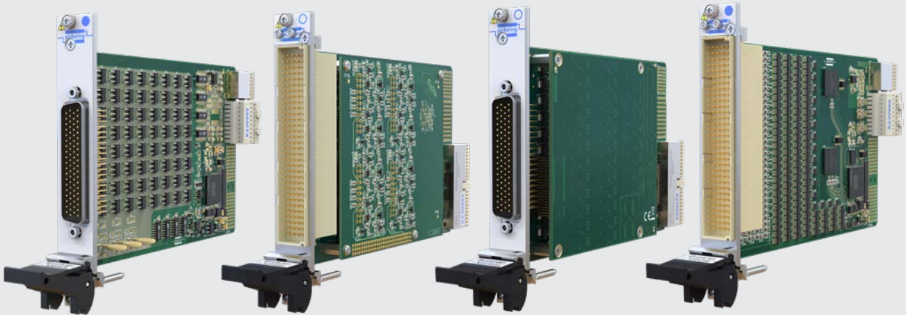
그림 10 - 디지털 신호 생성 및 감지를 위해 설계되었으며, 오류 보호 기능을 갖춘 테스트 분야에 적합한 산업용 디지털 입출력 제품군.
