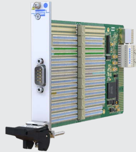
그림 7 - 피커링 인터페이스 PXI/PXIe 15W 프로그램 가변 저항 모듈은 0.125Ω 단위로 프로그래밍이 가능하며, 제품에 따라 1Ω에서 395kΩ까지의 저항 값을 지원.
