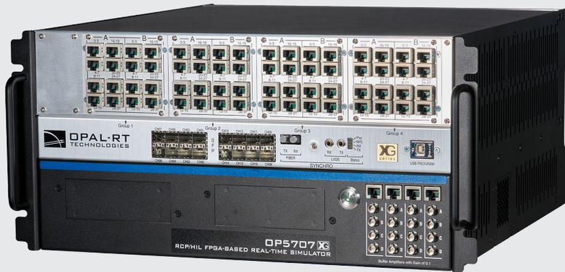
图 5 - OPAL-RT OP5707XG 配备 Intel® Xeon® 处理器、最高 16 GB 内存、250 GB 固态硬盘,具备四个以太网端口 (两个 1 Gbps, 两个 10 Gbps)、USB 3.2 接口、HDMI 与 VGA 视频输出,以及一颗 Virtex®-7 FPGA,用于亚微秒级的实时仿真。
