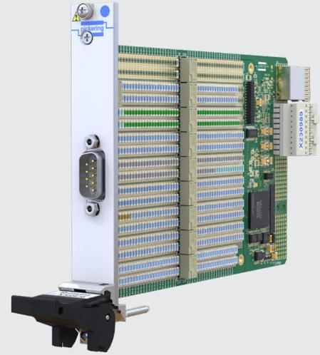
图 7 - Pickering Interfaces 的 PXI/PXIe 15 W 可编程电阻模块支持最小至 0.125 Ω 的编程步进，具体电阻范围根据型号不同可覆盖 1 Ω 至 395 kΩ。
