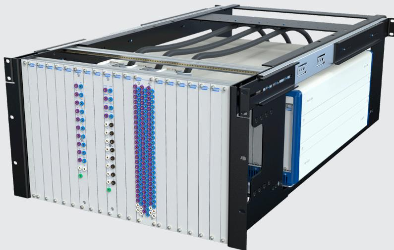
图 12 – 通过使用插拔模块将故障注入单元 (FIU) 机箱直接对接至接线盒 (BoB), 显著减少了线缆连接, 从而实现更紧凑、更可靠的系统设计, 并有效提升信号完整性。
