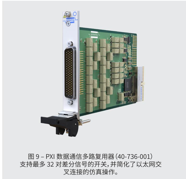
图 9 – PXI 数据通信多路复用器 (40-736-001) 支持最多 32 对差分信号的开关，并简化了以太网交叉连接的仿真操作。
