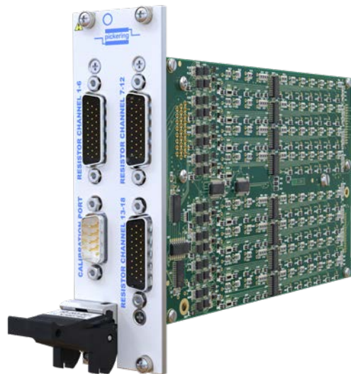
그림 3 --150~850°C 온도 범위에서 PT100의 저항이 어떻게 변화하는지 시뮬레이션하기 위한 3U PXI RTD 모듈, '40-263-001'
