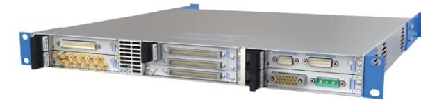
6槽机箱高度为1U, 可安装进19英寸宽的机柜, 适合便携式和空间有限的机柜安装应用。这款机箱还具有高效的直接对流的冷却设计, 最大程度地确保模块不会过热。
