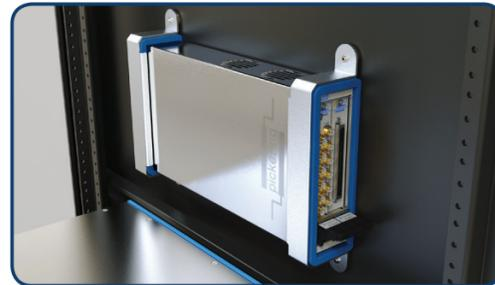
可使用选配的磁性/螺钉固定支架将机箱垂直安装于测试机柜内。
