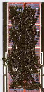
使用接线板手动注入故障的传统故障注入系统
